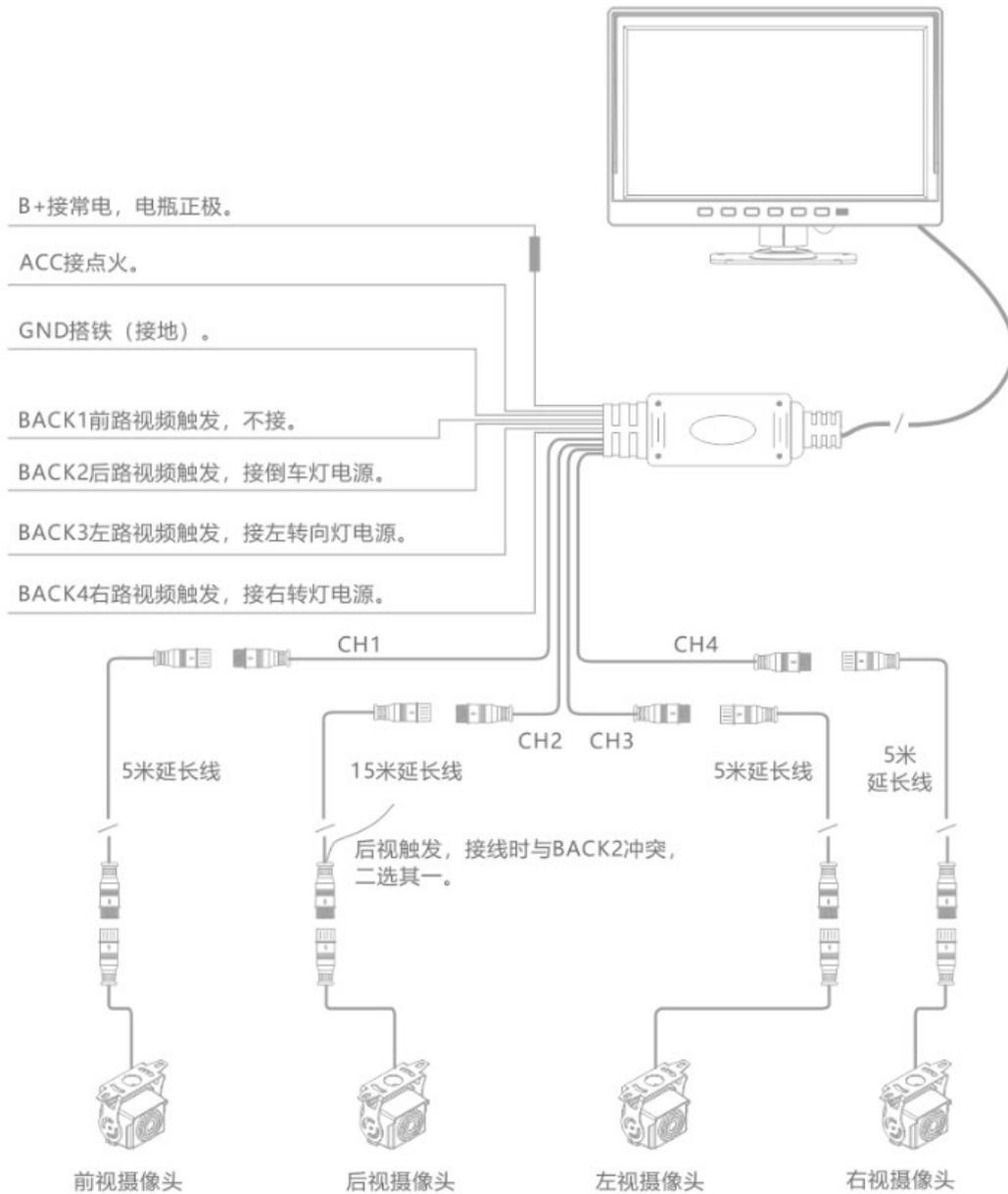
温馨提示：图中摄像头样式仅供参考，建议专业车装接电人员进行安装；ACC接点火线，当车熄火后屏幕会延时关闭，B+接通常电，车熄火后系统会保存设置好的时间，否则不保存；触发线和视频线严格按照线标和安装示意图进行安装，否则屏幕显示画面错乱。
